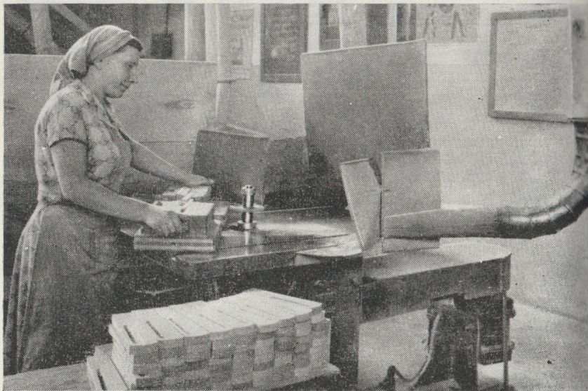
Рис. 59. Выборка пазов (пролеток) у гитарных головок на фрезерном станке
