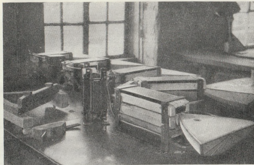
Рис. 91. Приклеивание наклеек к ручкам балалаек в пневматических прессах с низковольтным контактным электрическим нагревом
