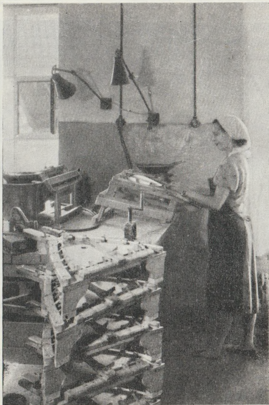
Рис. 90. Приклеивание обкладки к балалайкам
